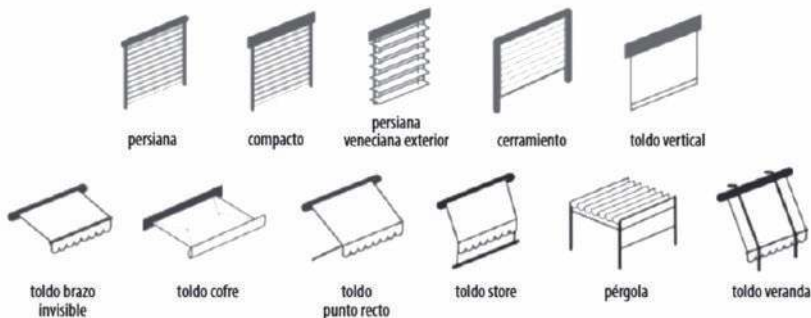
Figura 13. Ejemplos de sistemas de protección solar [12]
